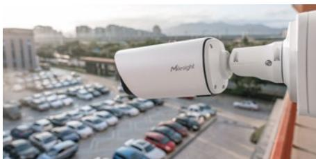
Die digitale Bildstabilisierung (EIS, Electronic Image Stabilisation) kann leichte Bewegungen der Kamera ausgleichen, die zum Beispiel durch Wind entstehen, wenn die Kamera an einem Mast befestigt ist.
