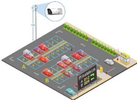
Die Kamera wurde für eine effiziente und intelligente Parkraumbewirtschaftung im Freien entwickelt. Sie verfügt über einen KI-basierten Algorithmus, mit dem die Belegung von bis zu 100 Parkplätzen gleichzeitig gemessen werden können.
